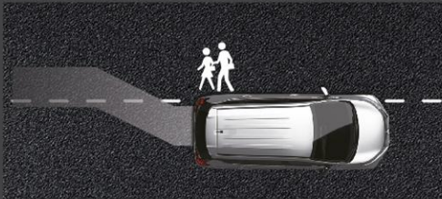
ANTI-LOCK BRAKING SYSTEM (ABS) ระบบเบรกแบบป้องกันล้อล็อก จะทำงานกับที่เหยียบเบรกกระทันหัน ช่วยให้คุณหักหลบสิ่งกีดขวางในขณะเหยียบเบรกได้อย่างทันถ่วงที
