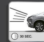
COMING HOME LIGHT ระบบไฟนำทางหลังดับเครื่องยนต์ ให้ง่ายต่อการเข้าหาตัวภายใน 60 วินาที หลังดับเครื่องยนต์ ไฟหน้าจะอยู่ในตำแหน่งไฟต่ำ และทำงานเป็นเวลา 30 วินาที เพื่อความสะดวก และปลอดภัย
