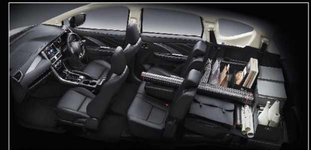
พนักพิงหลังเบาะที่นั่งแถวที่ 2 แยกพับแบบ 40 : 20 : 40 เบาะที่นั่งแถวที่ 3 พับแนวราบ
