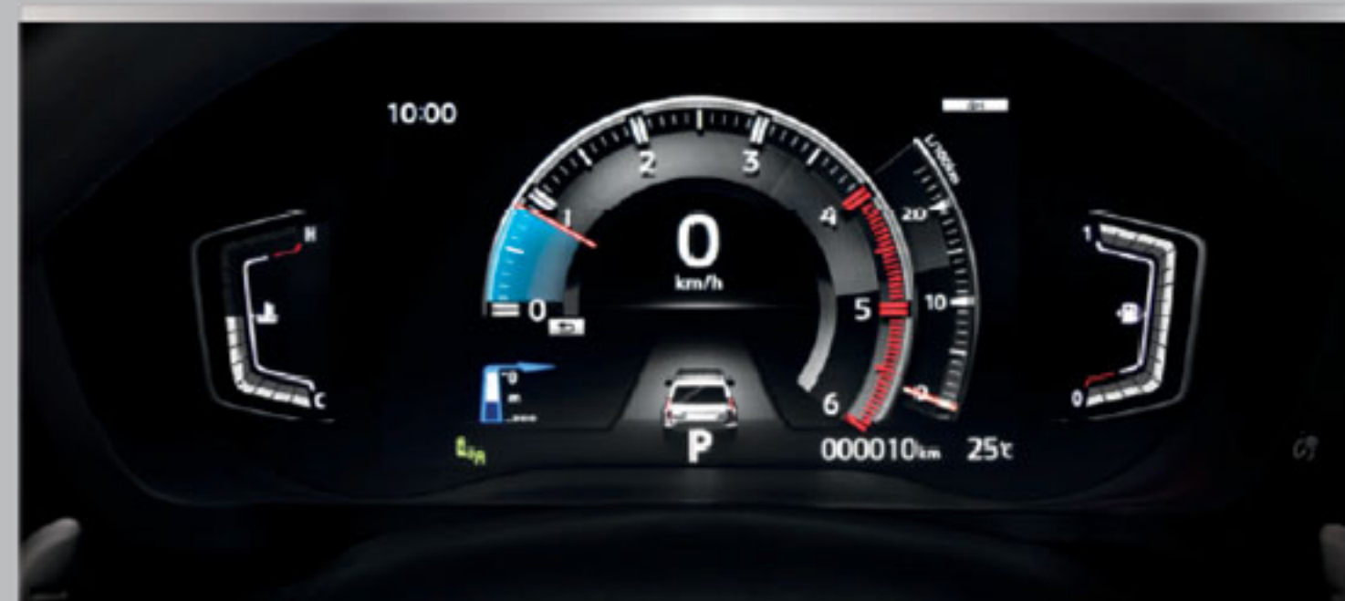
8" COLOR LCD MULTI-INFORMATION DISPLAY จอแสดงข้อมูลการขับขี่แบบ LCD ขนาด 8 นิ้ว ปรับเปลี่ยนรูปแบบหน้าจอได้ 3 แบบ รองรับเมนูภาษาไทย พร้อมเชื่อมต่อและแสดงข้อมูลจากหน้าจอสัมผัส SDA (Smartphone-Link Display Audio) ให้คุณไม่ต้องละสายตาจากท้องถนนเพื่อการขับขี่ที่ปลอดภัย
