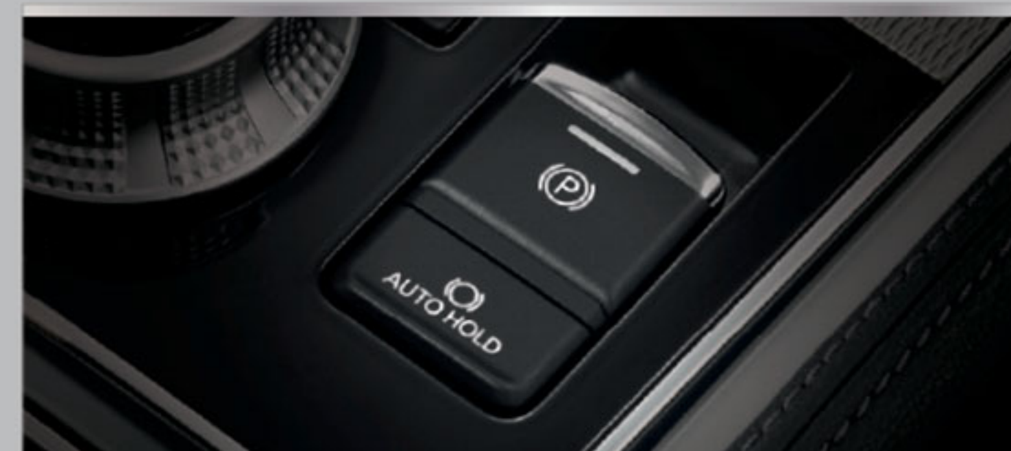
AUTO PARKING BRAKE & BRAKE AUTO HOLD ระบบเบรกมือควบคุมด้วยไฟฟ้าอัตโนมัติ จะทำงานเมื่อเลื่อนคันเกียร์ไปที่ตำแหน่ง "P" และจะปลดล็อกอัตโนมัติเมื่อเลื่อนคันเกียร์ออกจากตำแหน่ง "P" ระบบ BRAKE AUTO HOLD เพียงกดปุ่ม AUTO HOLD ให้ระบบเริ่มทำงานเมื่อคุณเหยียบเบรก เพื่อให้รถหยุดนิ่งจนไฟเขียวแสดงบนหน้าปัด (ขณะที่ยังอยู่ในตำแหน่ง "D" หรือ "N") ระบบจะทำงานและทำให้รถหยุดโดยไม่ต้องเหยียบเบรกค้างไว้ ระบบจะปลดเบรกอัตโนมัติเมื่อเหยียบคันเร่ง สะดวกสบายมากยิ่งขึ้น แม้ในสภาวะการจราจรติดขัด
