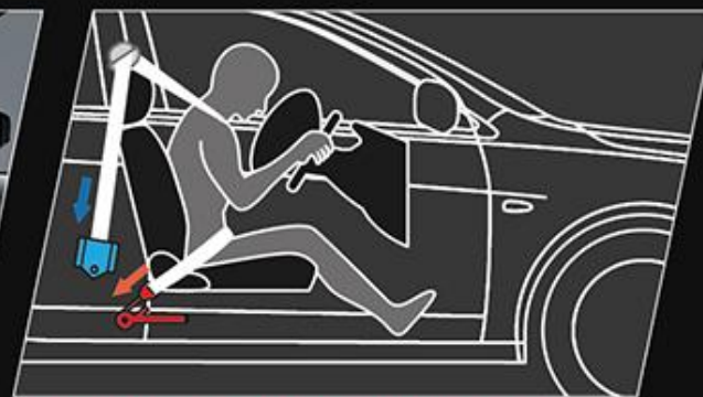
2-WAY PRETENSIONER WITH FORCE LIMITER FRONT SEATBELTS (DRIVER SIDE) เข็มขัดนิรภัยด้านคนขับแบบดึงกลับ และผ่อนแรงอัตโนมัติ แบบ 2 ทิศทาง
